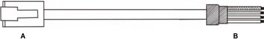
图4.9 伺服驱动器与PLC通讯线缆示意图
